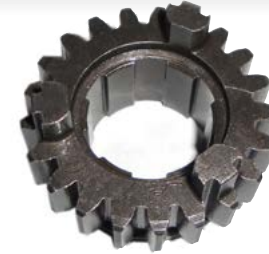
6304-000 ENGRANAJE 5º VELOCIDAD SOBRE SECUNDARIO Z-20
