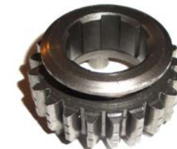
7124-000 ENGRANAJE 5º VELOCIDAD SOBRE SECUNDARIO Z-21
