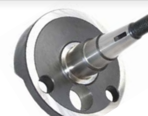
486-PRO MEDIO CIGUEÑAL LADO VOLANTE (CARRERA 52) Bancada de 25/ Muñon 18 mm
