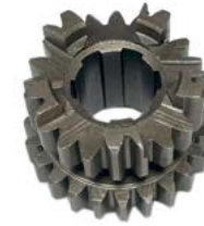
7317-000 ENGRANAJE 5º y 6º VELOCIDAD SOBRE PRIMARIO Z-20-23
