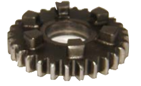
7002-000 ENGRANAJE 3º VELOCIDAD SOBRE SECUNDARIO Z-29
