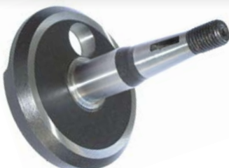
312-000 MEDIO CIGUEÑAL LADO VOLANTE REDONDO (CARRERA 39)
