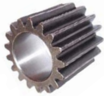
3740-000 ENGRANAJE DE TRANSMISION Z-17 (ALTO) (LARGO TOTAL 31 mm)
