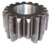
3340-C50 ENGRANAJE 2º VELOCIDAD SOBRE ARBOL PRIMARIO Z-16
