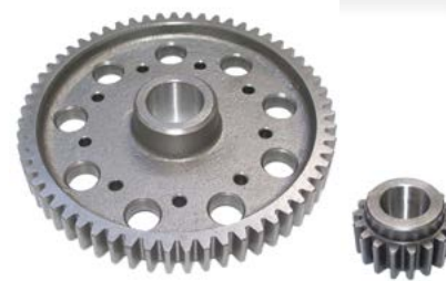
469-PRO CORONA Y PIÑÓN DE EMBRAGUE CON DIENTE RECTO Z.17-59 (CEMENTADO)
