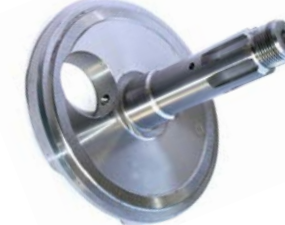
3780-000 MEDIO CIGUEÑAL LADO EMBRAGUE (Nº1) SMASH/FU/GLA torta 96 mm (CARRERA 55,5)
