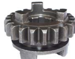
3351-C50 ENGRANAJE 3º VELOCIDAD SOBRE ARBOL PRIMARIO Z-21 (VARIEDAD)
