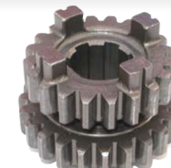
4101-000 ENGRANAJE 3º Y 4º VELOCIDAD SOBRE PRIMARIO Z.23-20
