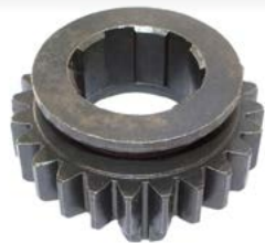
4174-000 ENGRANAJE 5º VELOCIDAD SOBRE SECUNDARIO Z-24
