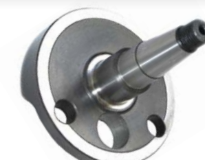
471-PRO MEDIO CIGUEÑAL LADO EMBRAGUE (CARRERA 52) Bancada de 25/ Muñon 20 mm
