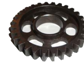
7120-000 ENGRANAJE 2º VELOCIDAD SOBRE SECUNDARIO Z-28
