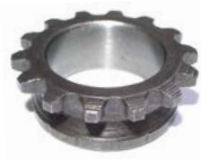
566-000 ENGRANAJE PUNTA DE CIGUEÑAL Z-14 /25H ZANELLA ZB 110D/ 110D SEXY/SWING/SHARK
