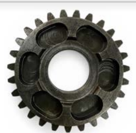
8133-000 ENGRANAJE 3º VELOCIDAD SOBRE SECUNDARIO Z-27
