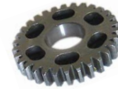
7204-000 ENGRANAJE 2º VELOCIDAD SOBRE SECUNDARIO Z-30
