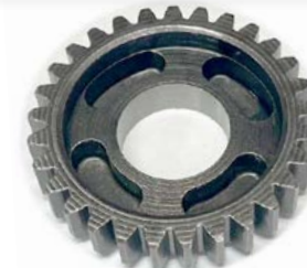
8333-000 ENGRANAJE 6º VELOCIDAD SOBRE SECUNDARIO Z-29
