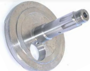
3609-000 MEDIO CIGUEÑAL LADO EMBRAGUE 1992 EN ADELANTE (CARRERA 41,2)
