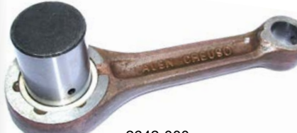
2642-000 HONDA XR 100 cc (MODELO NUEVO) (4T) MUÑON C/AGUJERO (STANDARD)
