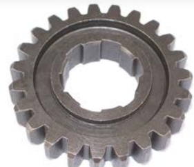
3504-100 ENGRANAJE 4º VELOCIDAD SOBRE SECUNDARIO Z-23 - C 100
