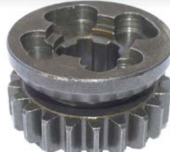
3516-000 ENGRANAJE 3º VELOCIDAD SOBRE PRIMARIO Z-21 (4 CORREDERAS) C/CD100
