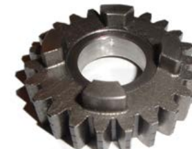
8303-000 ENGRANAJE 4° VELOCIDAD SOBRE SECUNDARIO Z-23
